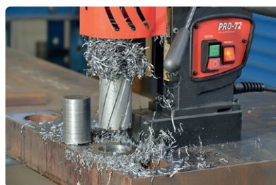
Maximális mélység 75 mm-ig (3") Max löket 190 mm-ig (7-1/2")
