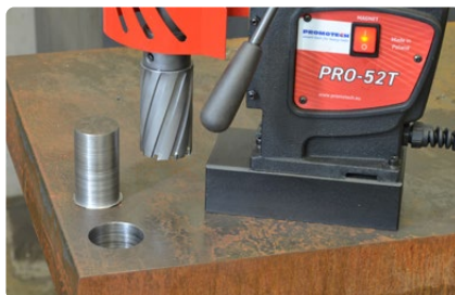
Akár 50mm-es marási teljesítmény • Max. mélység akár 75mm
