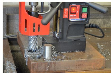
Marási teljesítmény 50 mm-ig (2") Vágásmélység akár 75 mm (3") - opcionális
