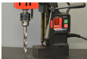
Adapter MT2 x 1/2" 20 UNF, Fúrótokmány 1/2" 20 UNF Csigafúrók Ø 16.0 mm-ig (DIN 338)
