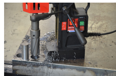
Marási kapacitás 55 mm-ig (2,17") Vágásmélység 75 mm-ig (3")
