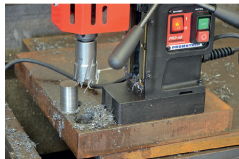
Marás kapacitás 40 mm-ig (1.57") Vágás mélység 50 mm-ig (2")
