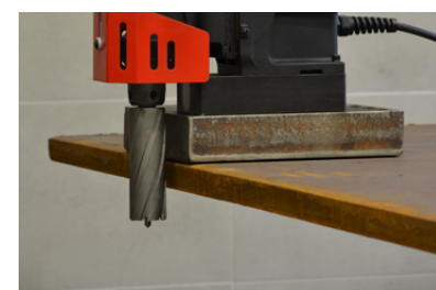
A fúrás kezdőpontja akár 50 mm-rel a fúróalap szintje alatt 100 mm hosszú maróval
