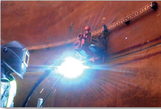
Rugalmas sín, hossza 185cm, 1 darab Minimális ívsugár: 1,0 m PRW-0466-50-01-01-0
