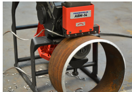
Ovális munkadarab és cső marása
