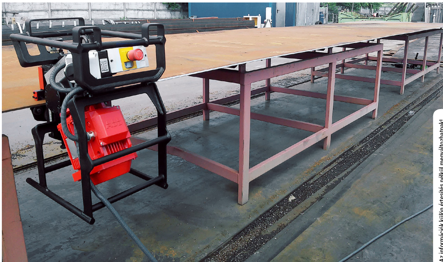
Az ABM-14 automatikusan halad végig egy lemezen
