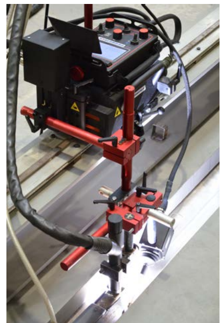
A varratkövetés oscillációval és anélkül is működik
