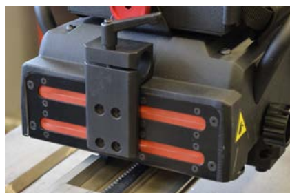
A szilikon borítás véd a szennyeződésektől és a fröccsenésektől
