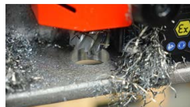
Max. marás kapacitás 40 mm
