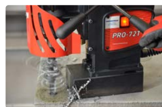
Fúrás kapacitás akár 25 mm (1") Max lökethossz akár 190 mm (7-1/2")
