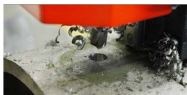
Max. fúrás kapacitás 16 mm
