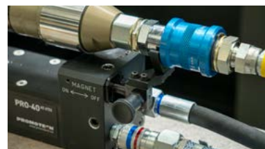
Védelem a motor véletlen beindítása ellen, ha a mágneses talp nincs aktiválva
