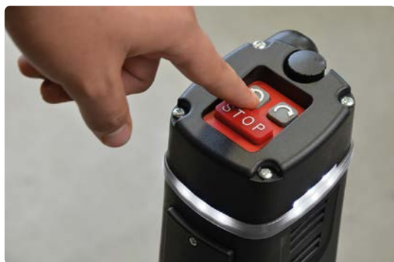
Óramutató járásával ellentétes (CCW) forgás Felhasználóbarát menetfúró szerszám kioldás vezérlés
