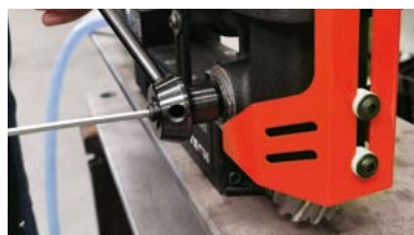
Az adagolófogantyú mindkét oldalról rögzíthető
