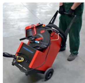
Hordozható hidraulikus tápegység polccal a lyukasztó szállításhoz.
