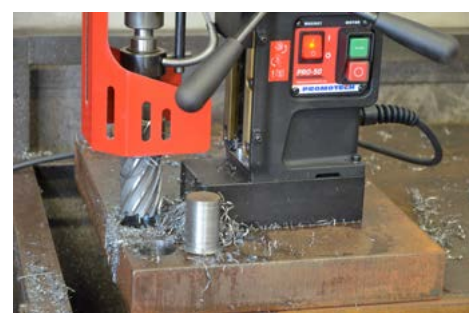
Marási teljesítmény 50 mm-ig (2") Vágásmélység akár 75 mm (3") - opcionális
