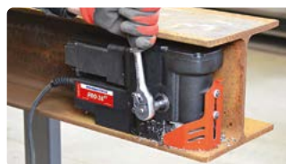
Kompakt kialakítás korlátozott magasságú területekhez. A levehető adagolókar (racsni) mindkét oldalról rögzíthető.
