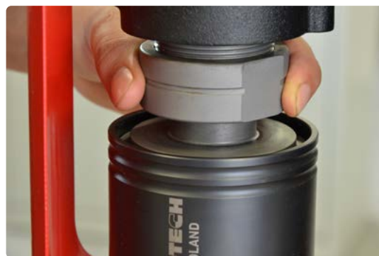
A rögzítőanyával ellátott menetfúró tokmány megvédi a menetfúró szerszámtól a kihúzóástól
