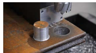
Max. vágás mélység 50 mm
