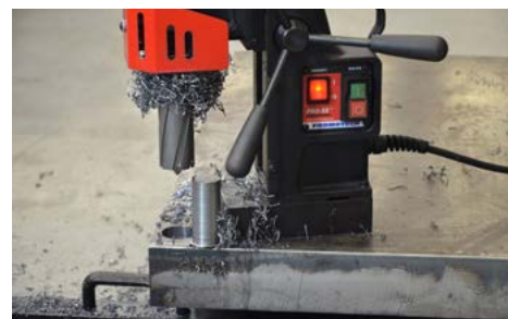
Marás kapacitás 45 mm (1.77") Vágás mélység 75 mm (3")
