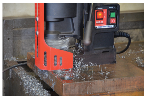
Marás kapacitás 55 mm-ig (2.17") Vágás mélység 75 mm-ig (3")
