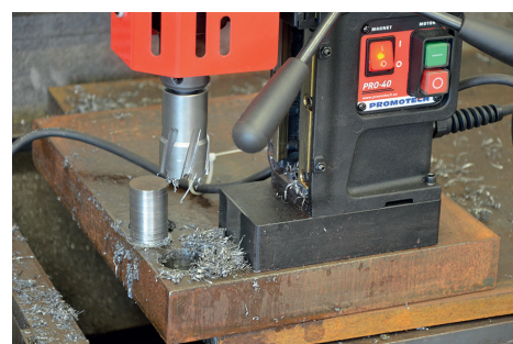
Marás kapacitás 40 mm-ig (1.57") Vágás mélység 50 mm-ig (2")
